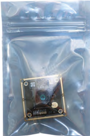
Scellez le plateau avec un sac antistatique
